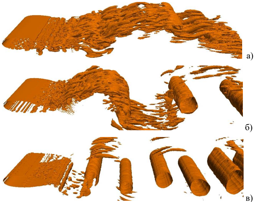
Рис. 6: Тривимірна вихрова структура течії за обтічним коливним крилом NACA0021 для різних частот коливань: Re=6 \cdot 10^4 , \alpha=15^\circ , St=0.12 , 0.24 , 0.36 (а–в).
