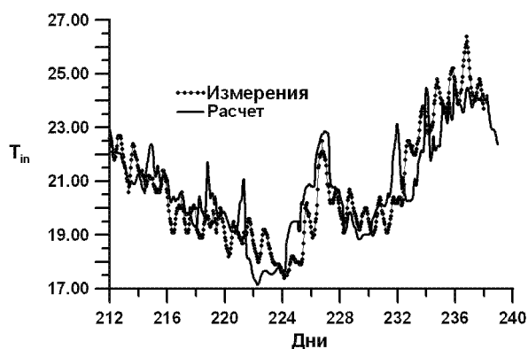
Рис. 10. Рассчитанная и измеренная температура на водозаборе ТЭС
