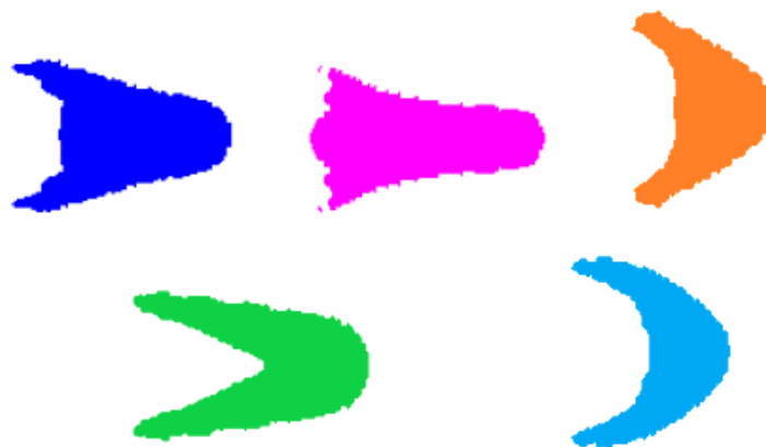
Рис. 2. Форми УЯ, які утворюються із різних металів. Верхній ряд справа наліво: середньовуглецева сталь, мідь, тантал; нижній ряд справа наліво: алюміній і армкозалізо
