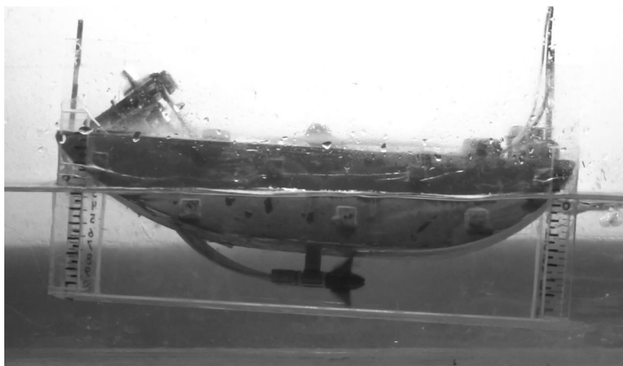
Рис. 10. Самохідний рух: H=0.11 м, V=0.53 м/сек, \bar{h}_x=0
