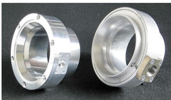
Рис. 11. Модели aspirатора № 2 (слева) и № 1 (справа)
