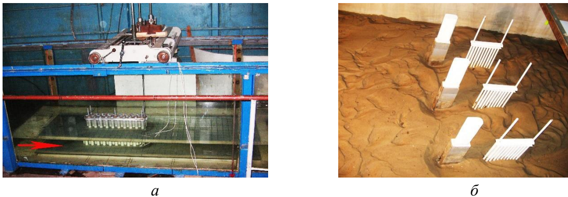
Рис. 2. Експериментальні стенди визначення впливу конструкцій моделей опор мостових переходів: а – нерозмивна модель та б – моделі на розмивному ґрунті.
