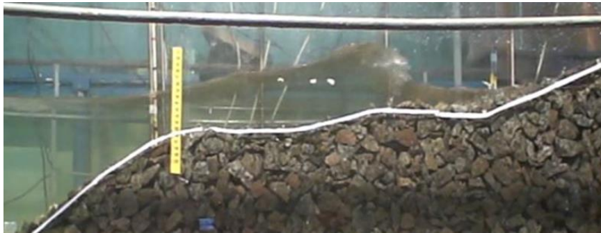
Рис. 2. Схема фізичної моделі з розташованими датчиками хвильового тиску.
