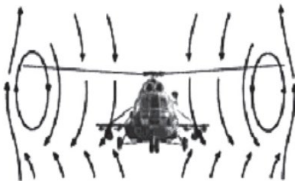
Рис. 1. Вихрове кільце на режимі вертикального спуску, V = 3-5 м/с
