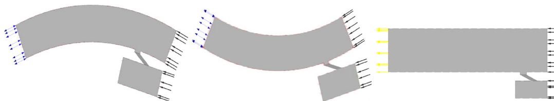
Рис 1. Геометрія досліджених геометрій (зліва направо): випукла, увігнута та плоска моделі
