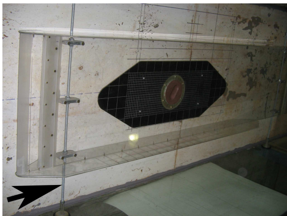
Рис. 1. Нахилена овальна лунка на обтічній поверхні пластини
