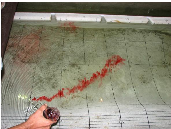
Рис. 8. Визуалізація приповерхностного слою потока перед полотном завеси
