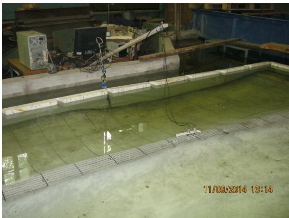
Рис. 6. Размеження датчиков швидкості, тиску і вибрацій в ізмірювальному учасьтку гідродинамічного каналу
