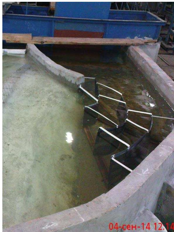
Рис. 4. Вхідна частина гідродинамічного каналу з направляючими потоки конструкціями
