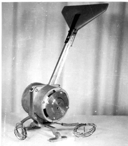
Рис. 2. Вид в сборке ПД с подпружиненным крылом и электромагнитным двигателем
