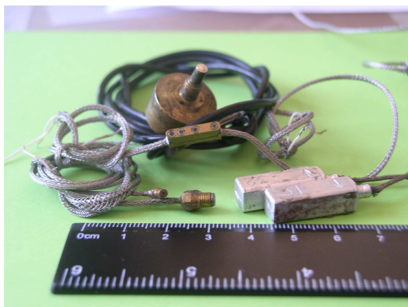
Рис. 1. Миниатюрные датчики пульсаций давления и виброакселерометры
