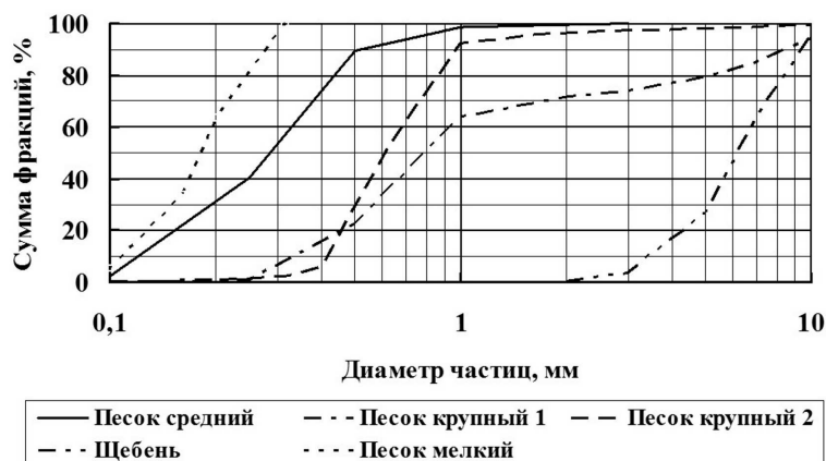
Рис. 3. Гранулометричний склад сыпучих ґрунтів
