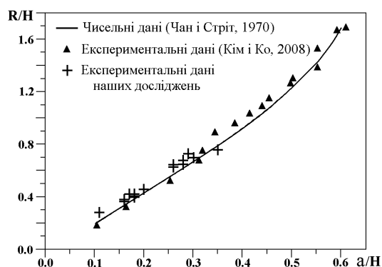
Рис. 8. Висота нахату відокремленої хвилі на вертикальну стінку: + – результати проведених досліджень величини нахату на вертикальний берег; ▲ – результати експериментальних досліджень Кім і Ко [18]; суцільна лінія – теоретичні дані Чен і Стріт [18]
