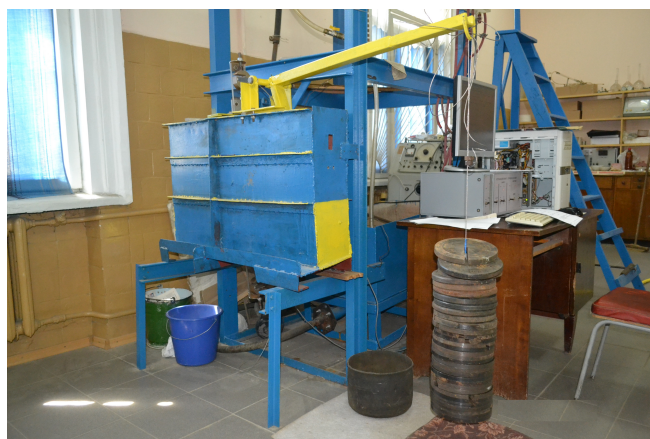
Рис. 2. Дослідна установка під час дослідження моделей конструкції для закріплення укосів і схилів
