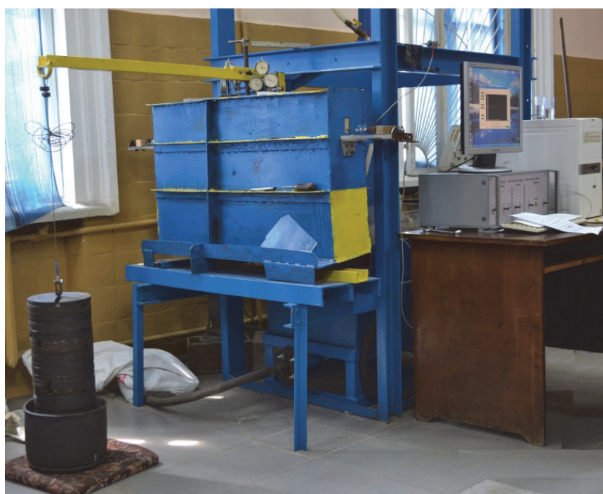
Рис. 4. Експериментальна установка під час дослідження моделей конструкції фундаментної подушки
