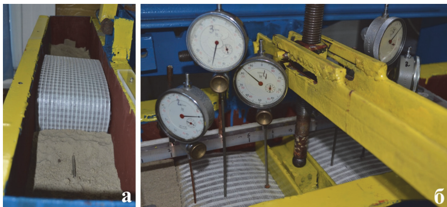
Рис. 6. Модель фундаментної подушки: а — під час закладання, б — під час дослідження
