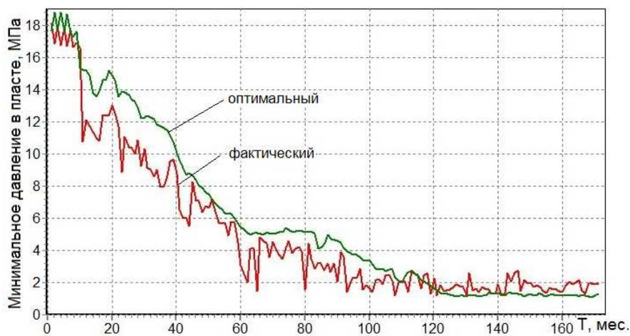
Рис. 6. Минимальное давления в пласте на Котелевском месторождении при оптимальном и фактическом режимах разработки
