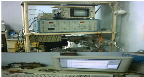
Рис. 1. Установка методики акустичної емісії на частоті f_{\parallel} = 0,200 \div 0,500 МГц \alpha = 70 дБ для вимірювання швидкостей пружних хвиль.
