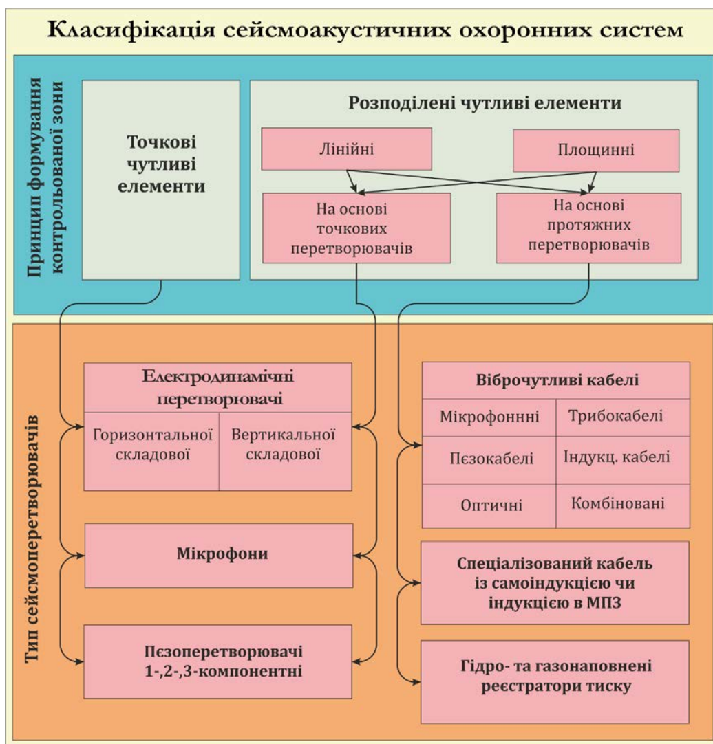
Рис 1. Класифікація сейсмоакустичних охоронних систем за типом використовуваних чутливих елементів та принципом їх розміщення в просторі
