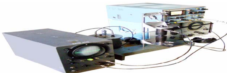
Рис. 3. Модернізована установка УЗВШ-КНУ. 1 – зразок, 2 – затримки, 3 – генератор, 4 – приймач, 5 – двохканальний осцилограф.
