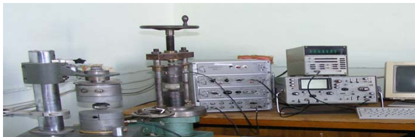
Рис. 2. Ультразвукова установка КЕРН-СГ для вимірювання швидкостей V пружних хвиль.
