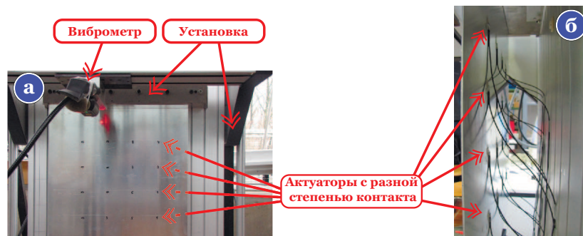
Рис. 1. Экспериментальная установка: фронтальный вид (а). Обратная сторона алюминиевой пластины с актуатором: вид сбоку (б).
