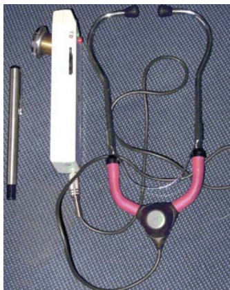
Рис.2. Общий вид электронного стетофонендоскопа с микрофонным сенсором.
