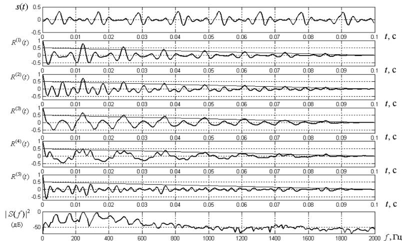
Рис. 3. Фонограмма хрипа, содержащего несколько гармоник, автокорреляционные функции, соответствующие пяти итерациям предложенного алгоритма выявления частот, доминирующих в спектре сигнала, и спектр мощности.
