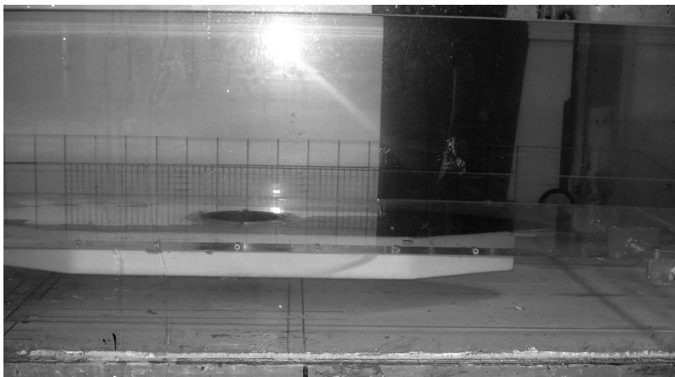
Рис. 1. Расположение пластины с полусферическим углублением в измерительном участке гидродинамического лотка
