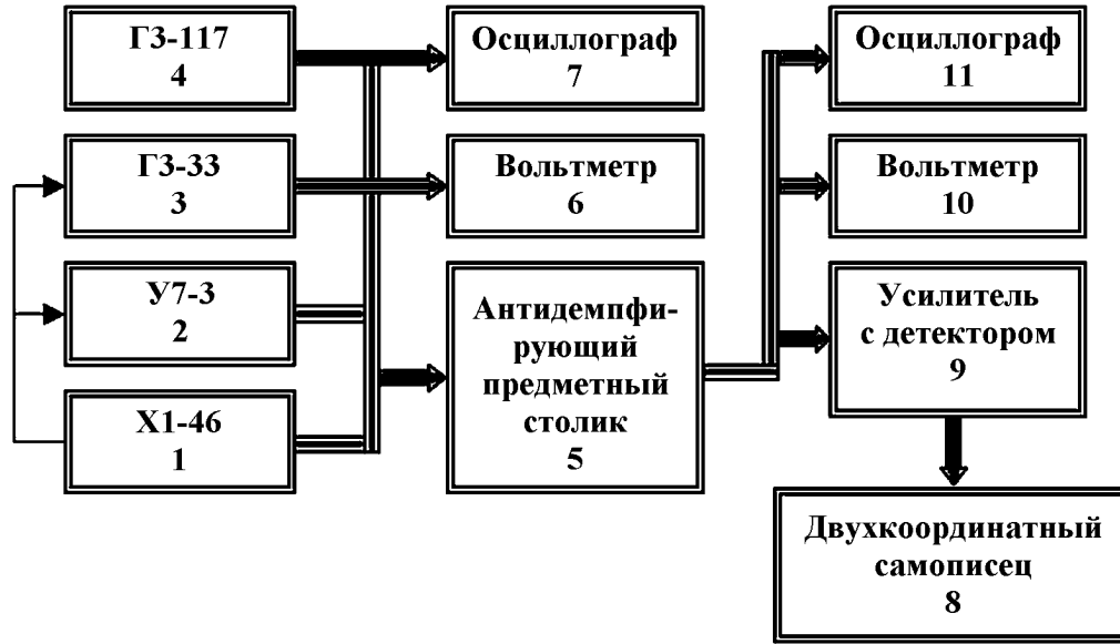
Рис. 2. Блок-схема электрической части экспериментального стенда
