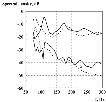
Рис. 2. Спектр мощности сигнала: 1 - z = 0.2 м, 2 - z = 0.8 м
